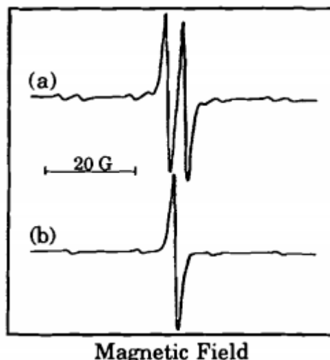
الشكل 5.7 : أطياف ESR a) [\text{ArCr}(\text{CO})_5(\text{PhC}\equiv\text{CH})\bullet^+] b) [\text{ArCr}(\text{CO})_5(\text{Me}_3\text{SiC}\equiv\text{CSiMe}_3)\bullet^+] في محلول \text{CHCl}_3 عند درجة حرارة الغرفة. منقول بإذن من N. G. Connelly et al., Journal of the Chemical Society, Chemical Communications, 1992, 1293. حقوق النشر © 1992 الجمعية الملكية للكيمياء.
