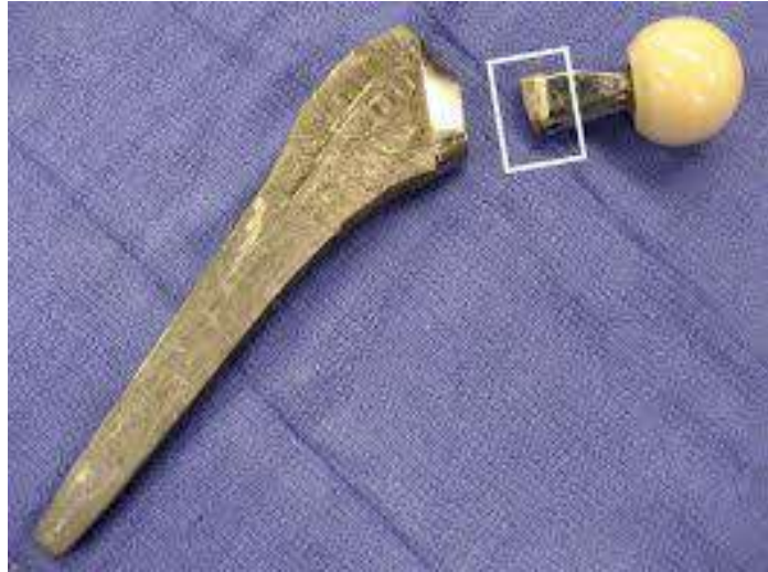
شكل (6.8): تشققات تآكل الإجهاد في الفولاذ المقاوم للصدأ وتلف مستبدل مفصل الورك.
