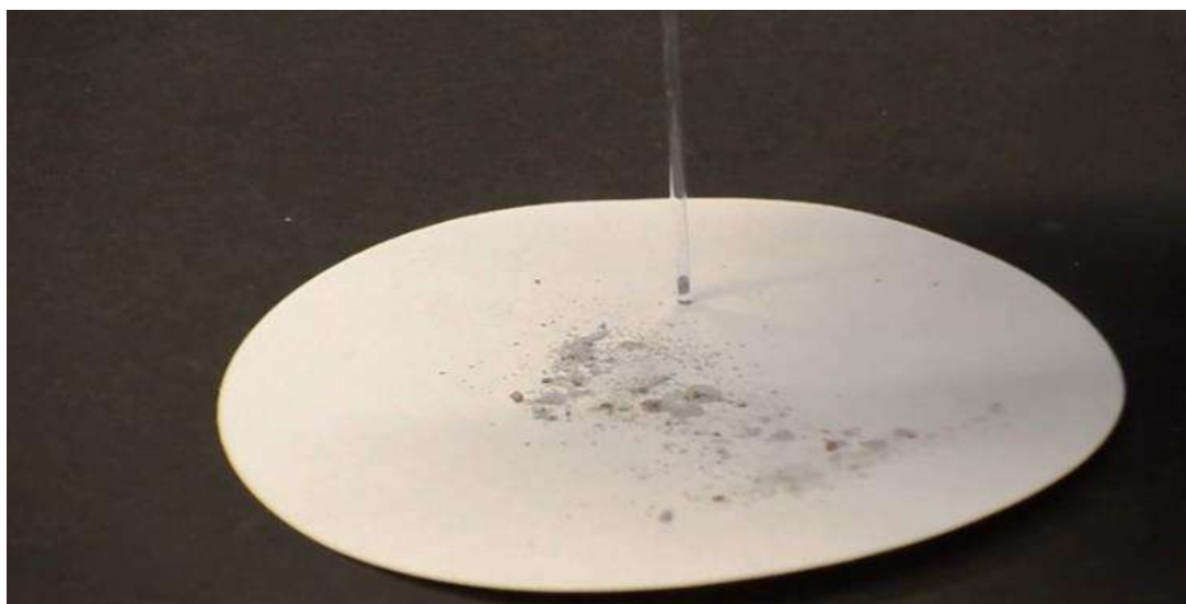
شكل (1): ضرب الطرف المفتوح للانبوبة الشعرية على مسحوق المادة الصلبة.
